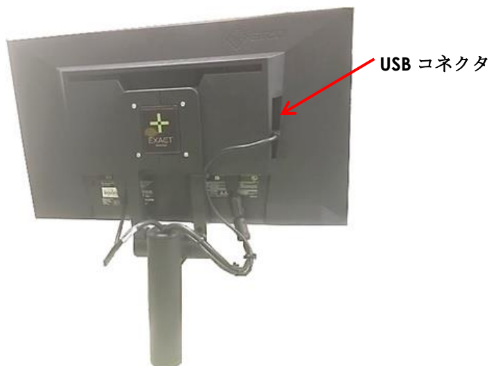
図 8 : モニター後部の USB コネクタ（一部の本装置の構成で利用可能）
