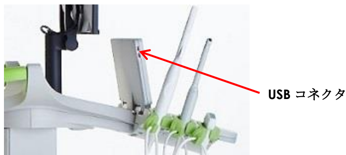
図 7 : タッチスクリーンの左側の USB コネクタ
