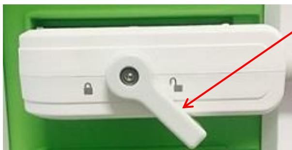
図 30 : ロック解除したトランスデューサコネクタロックつまみ
