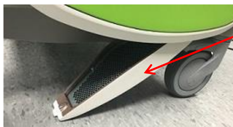
図 68 : 下部エアフィルタへのアクセス
