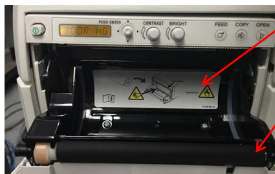
図 73 : プリンタのドアパネルを開く
